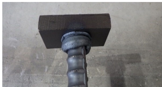
写真-2 プレート定着型鉄筋
