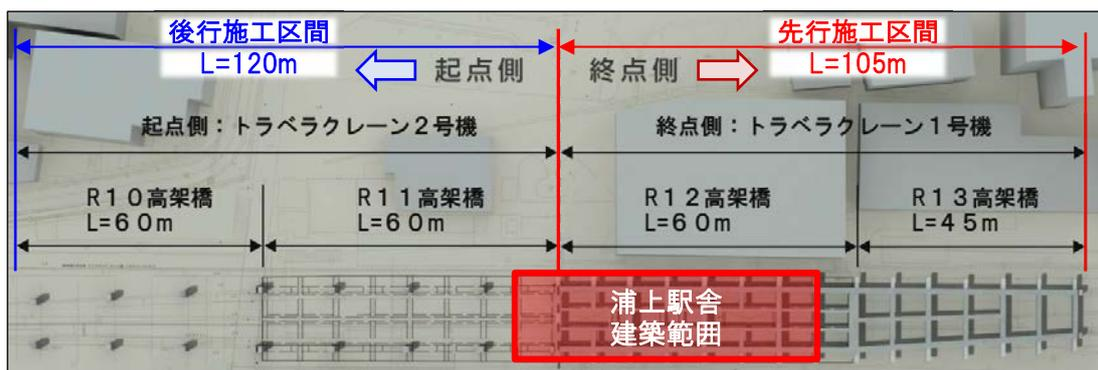
図-8 トラベラークレーンの配置台数・施工順序
