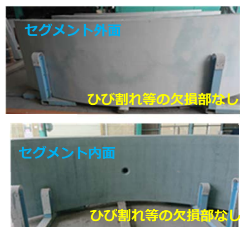
写真-4 セグメント脱型後の外観
