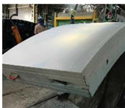
e) 蒸気養生/型枠脱型
