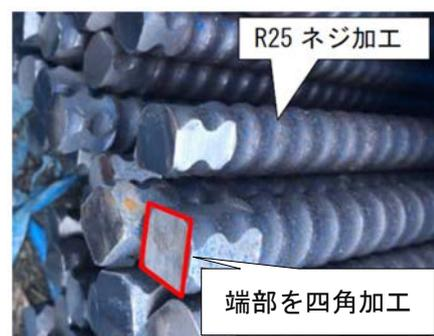
図-7 継ぎロックボルト（RS アンカー）
