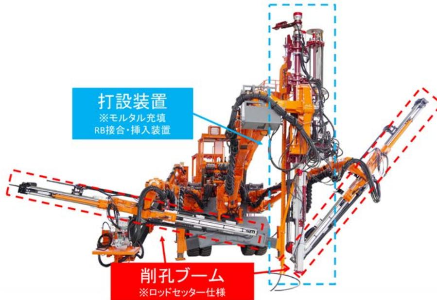
図-11 開発打設装置（ボルティンガー）
