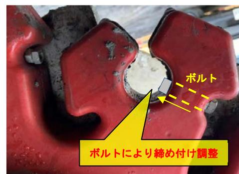
図-17 つかみ部へのボルト追加設置
