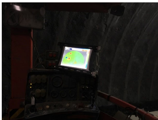
図-7 コンピュータジャンボ画面への配信
