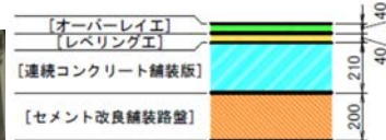
図-6 舗装構成比較図
