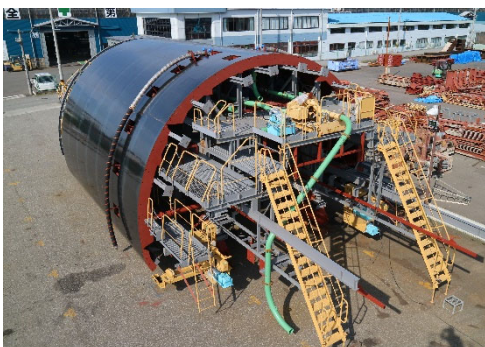
写真-6 打設システム全景
