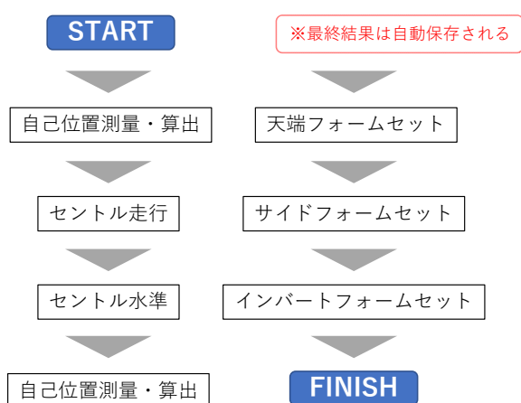
図-7 セントルセット概略フロー
