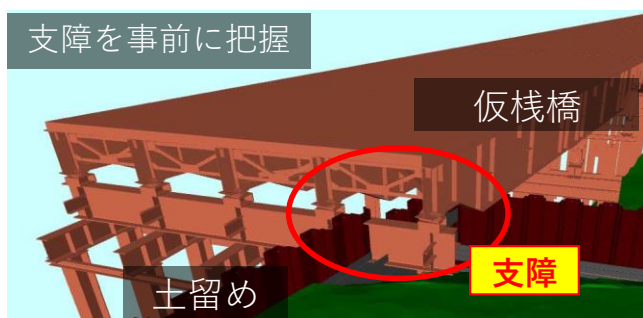
図-10 モデルデータによる干渉確認
