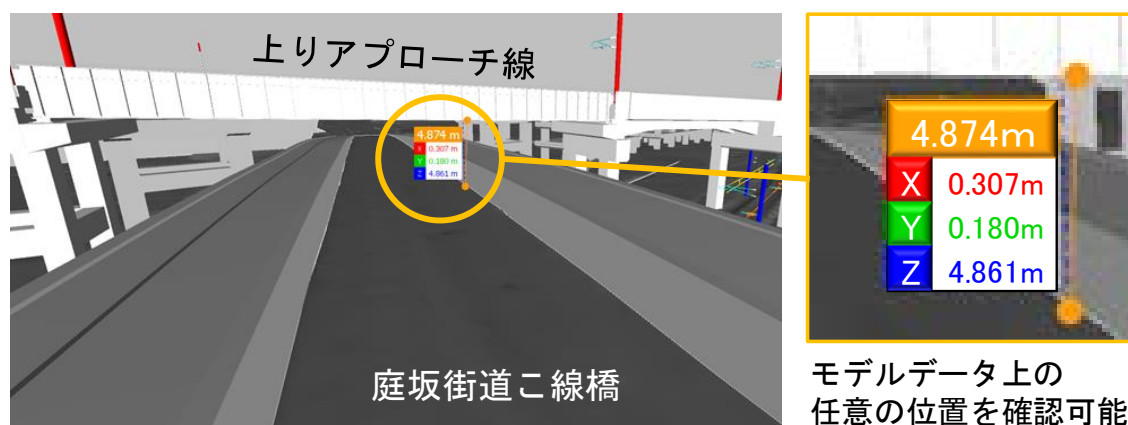
図-14 道路交差部の離隔確認
