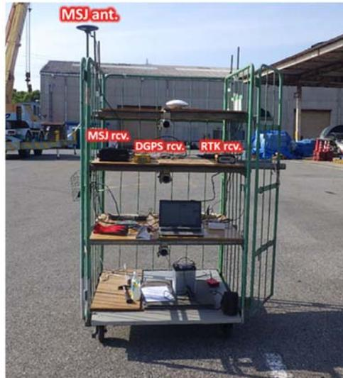
図-5 陸上精度検証 機材構成
