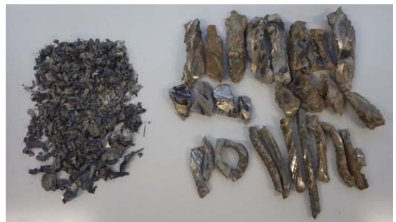
写真-6 杭切削後の鉄筋切削片
