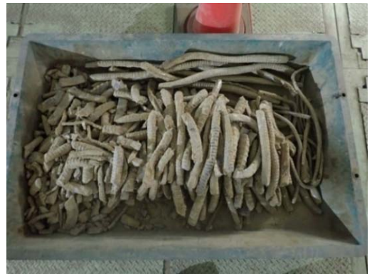
写真-7 白子川護岸区間の回収鉄筋片
