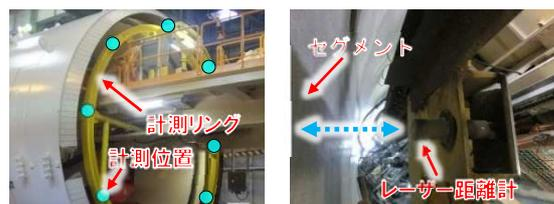
図-2 従来の真円度計測装置の例
