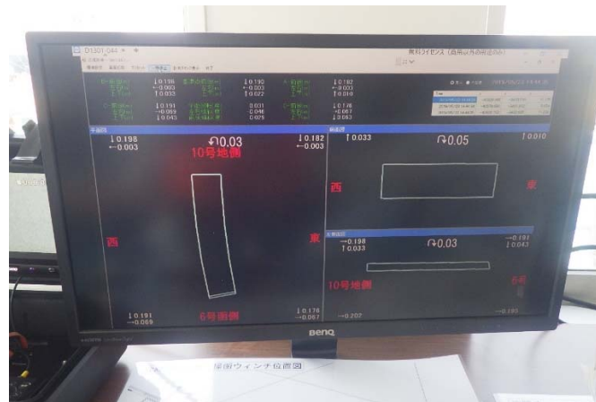
写真-22 沈埋函誘導システム（ブリッジ）
