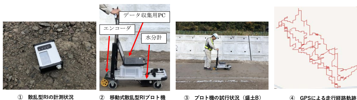
図-11 移動式散乱型 RI プロット機と試行状況（試験盛土 B）
