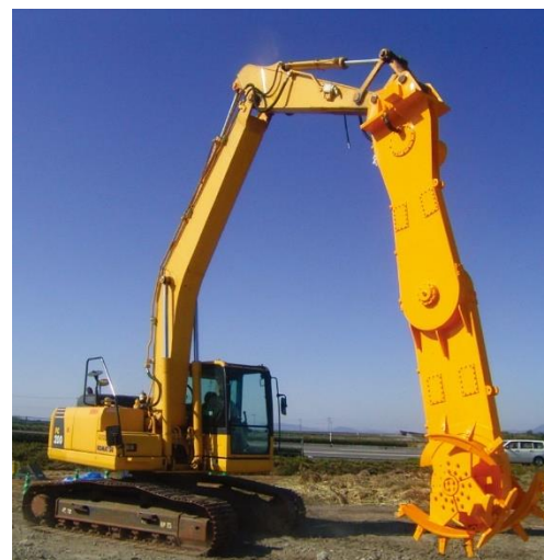
図-1 WILL 工法施工機械全景
