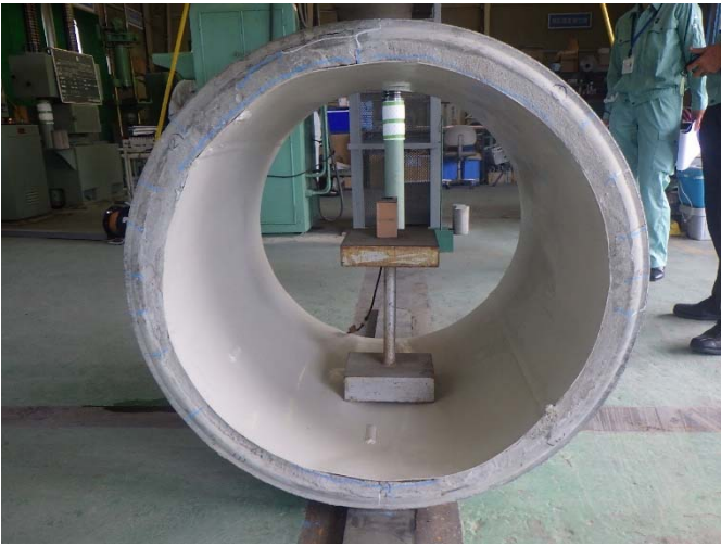
写真－2 側方曲げ強さ試験破壊後状況
