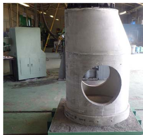
写真-1 軸方向耐圧強さ試験状況
