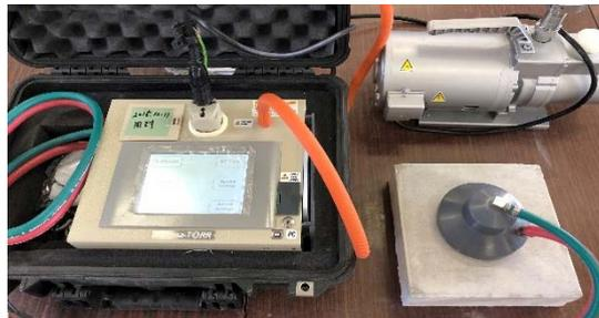
写真-4 表面透気試験状況
