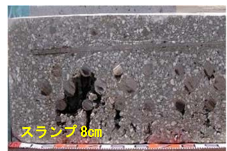
図-11 試験体からの切り出し箇所 (スランプ 8cm)
