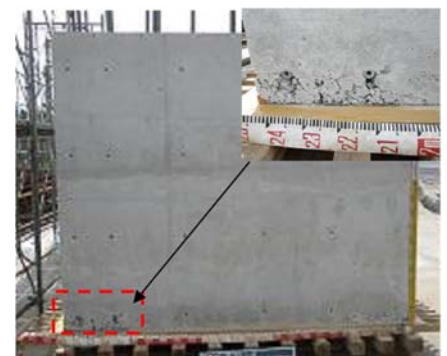
図-11 試験体からの切り出し箇所 (スランプ 8cm)
