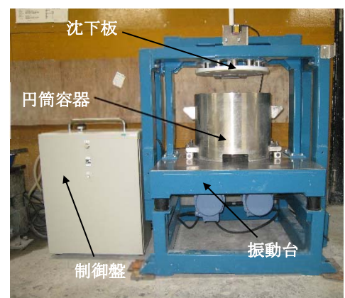
図-1 締固め試験装置
