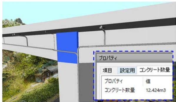
図-7 コンクリート数量照査
