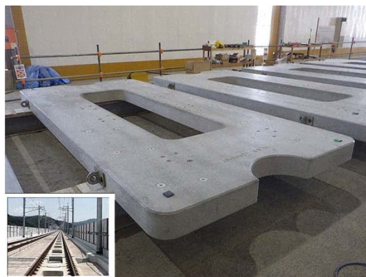
写真-2 軌道スラブ
