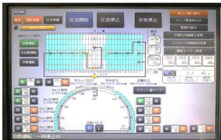
写真-4 打設制御装置のモニター画面
