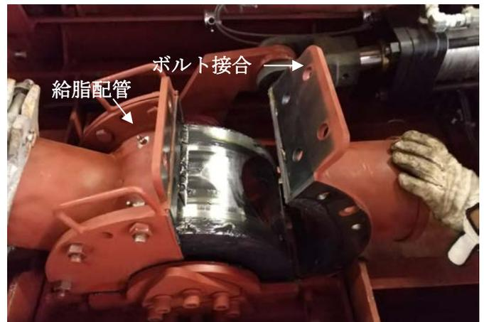
写真-9 改良版の回転式打設口
