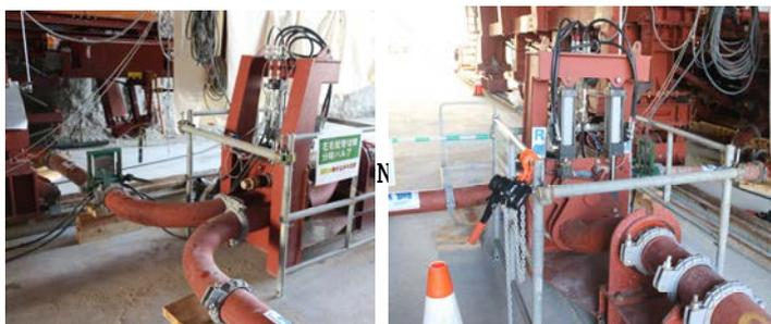
写真-3 配管系統の高速切替え装置
