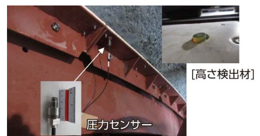
写真-2 浮き・剥落防止システム
