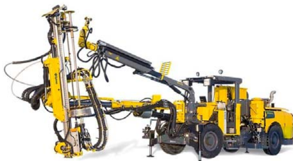
写真-7 ボルテック（ロックボルト作業の無人化（既往技術））
