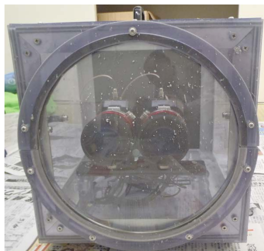
写真-5 吹付作業後のカメラボックス状況
