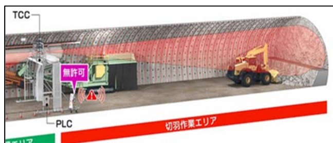
図-2 警告照明システム
