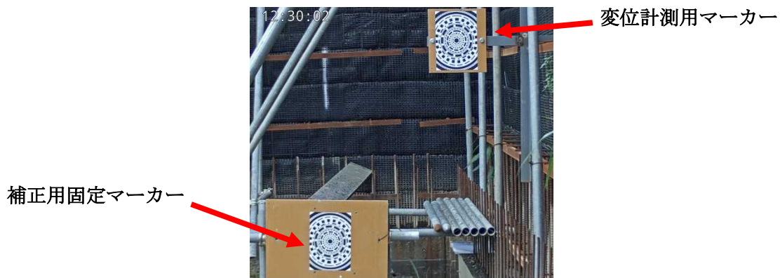
写真-3 盛土壁面変位の計測画像
