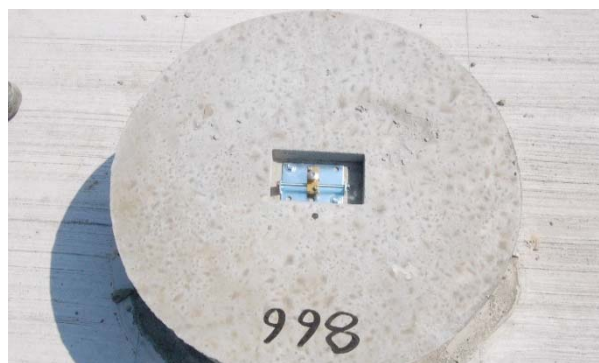
図-5 突起コンクリートに設置した基準器
