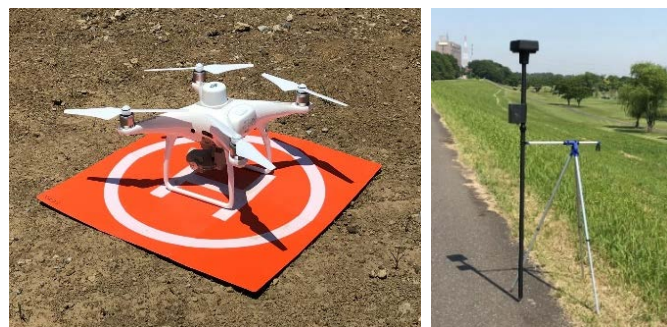
Phantom 4 RTK RTK-GNSS 基準局 写真-1 自己定位型 UAV
