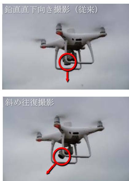
写真-2 斜め往復撮影 カメラ向き
