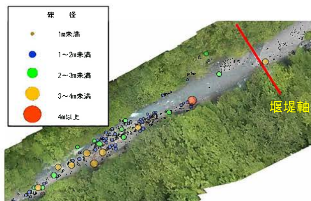
図-7 AI 石礫自動判読システムを用いた判読結果
