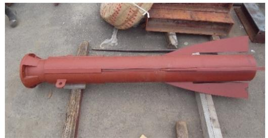
写真-7 トレミー管(スライド管を格納した状態)
