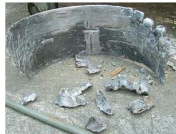
図10 鋼製カラーの破片
