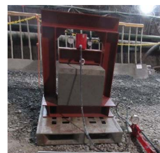
写真-4 白ゴム収縮量とひび割れ発生強度試験
