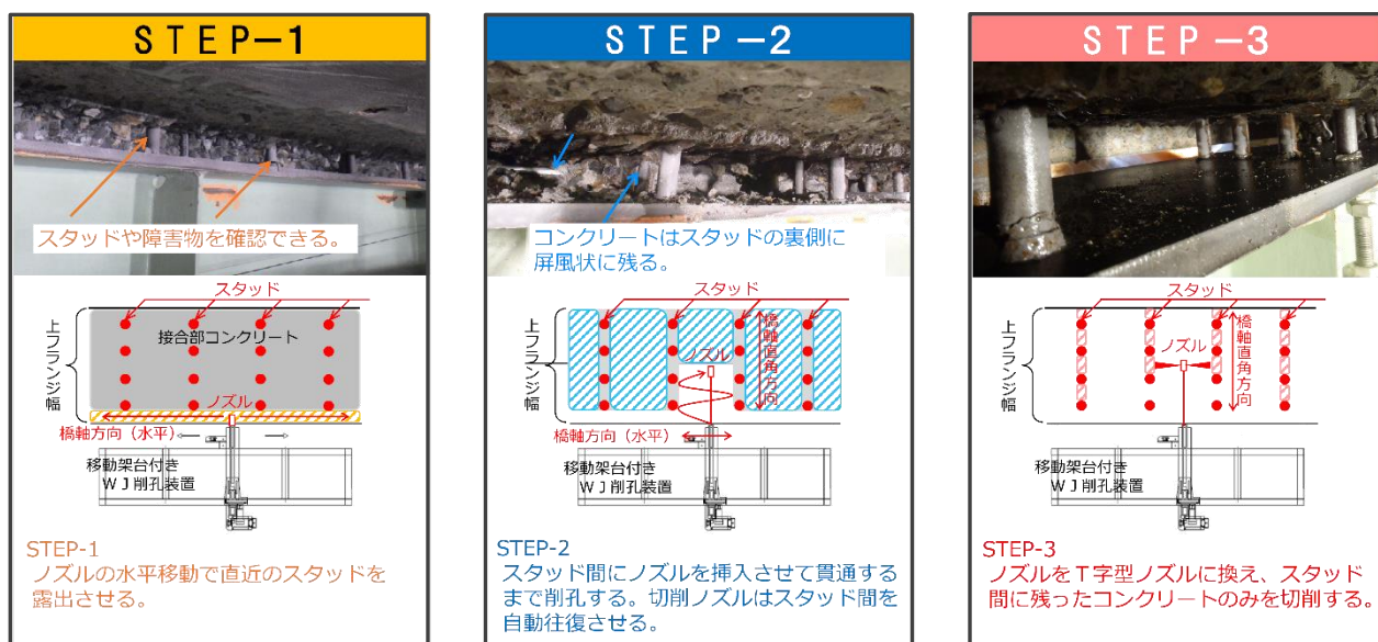
図-9 WJ による接合部コンクリートの除去(3-STEP)
