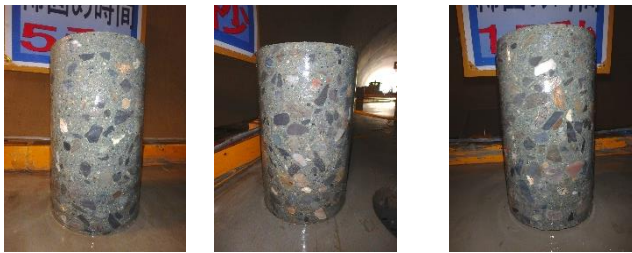
写真-3 気泡間隔係数測定用コア供試体
