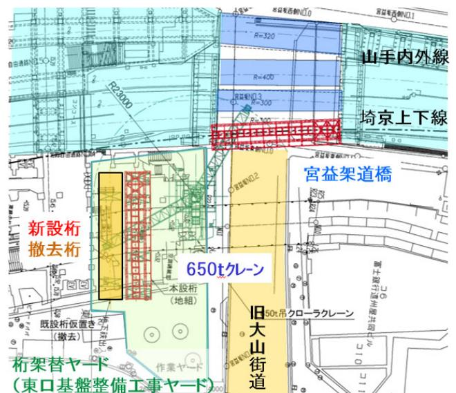
図-5 大型クレーン一括架替概要図
