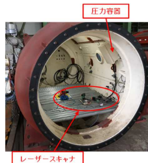
写真-2 レーザースキャナの耐圧試験状況
