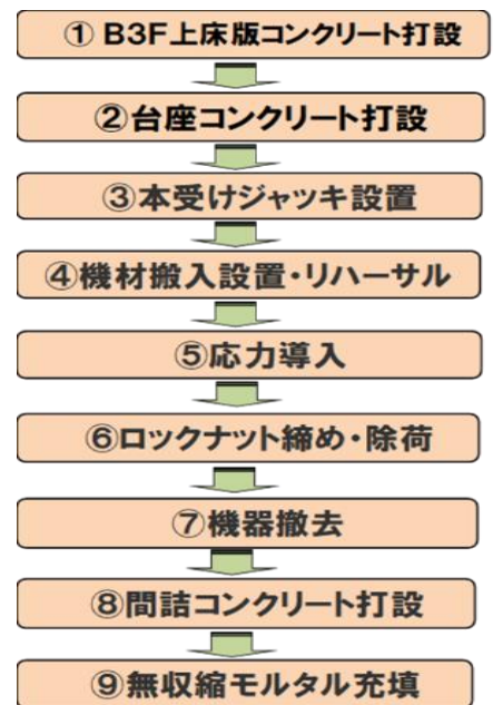
図-15 本受替え施工フロー
