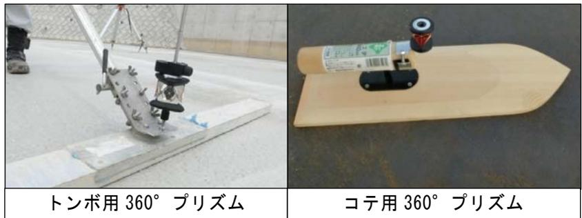
写真-2 測量用 360° プリズム取り付け
