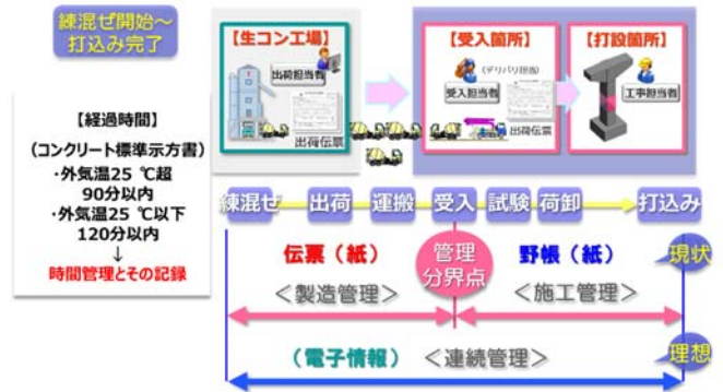
図-1 コンクリート工事の管理フロー
