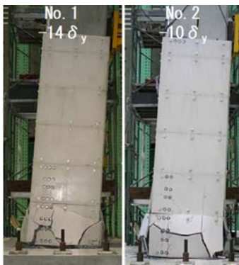
写真-1 終局時の損傷状況
