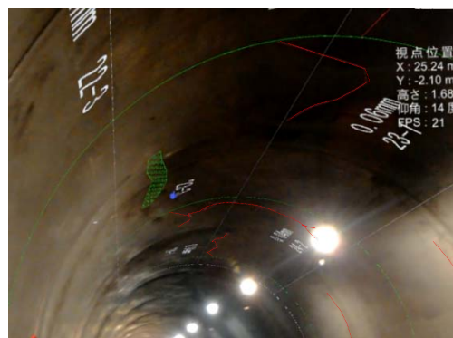
図-6 ひび割れ展開図表示例
