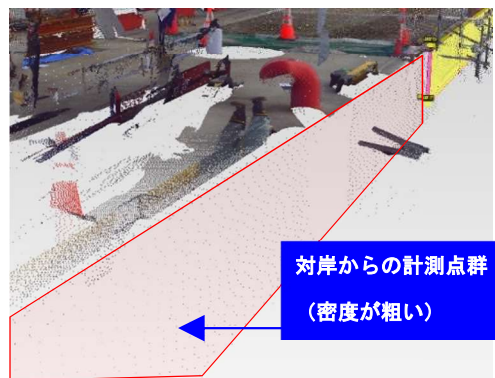
図-10 対岸からの岸壁法線計測結果
