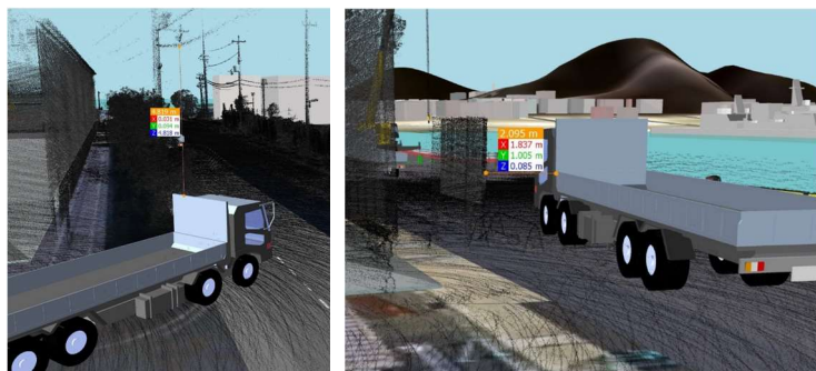
図-5 トラックと周辺構造物との離隔確認
