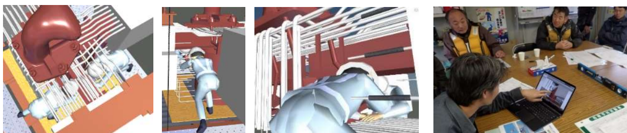
図-4 CIM モデルによる作業スペースの事前確認
