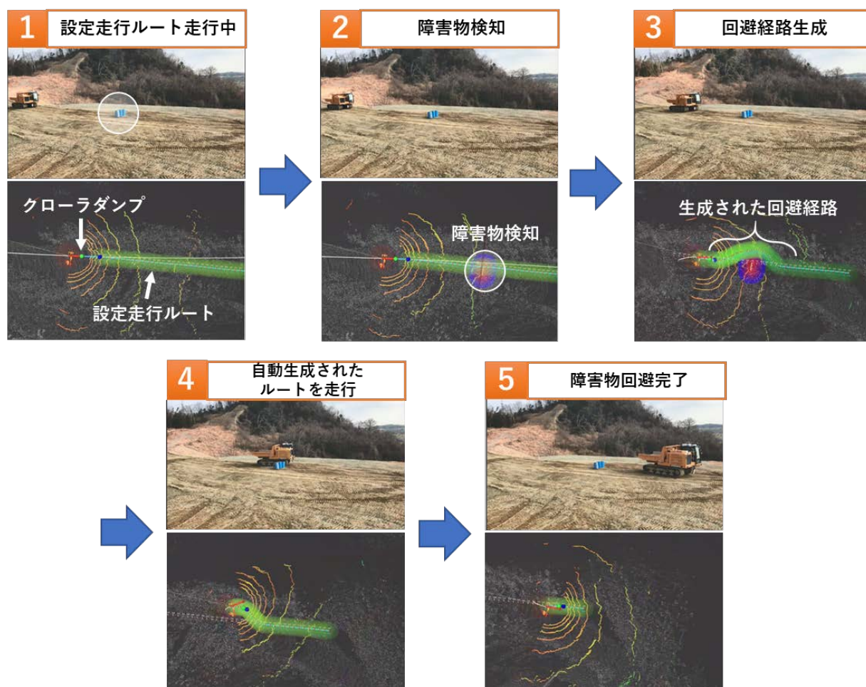
図-9 障害物回避状況
