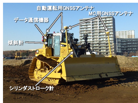
写真-2 ブルドーザと搭載機器
