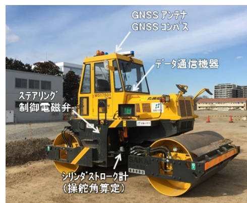
写真-1 振動ローラと搭載機器
