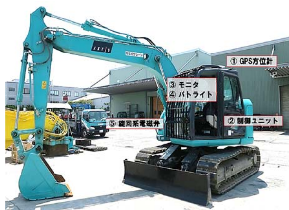
写真-2 バックホウに搭載する設備
