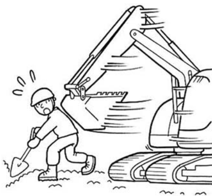
図-1 バックホウによる旋回事故例 厚生労働省（職場のあんぜんサイト）の事例より
