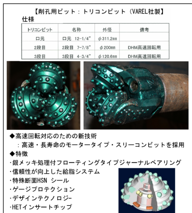
図-5 削孔ビット概要
