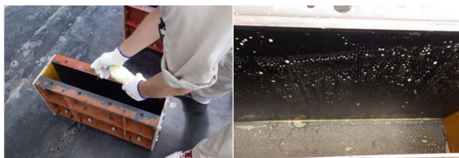
(左)噴霧時 (右)噴霧後完了後の拭き取り前
