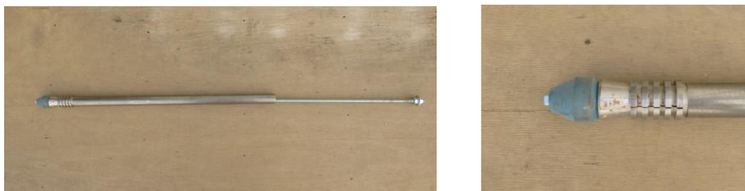
写真-7 止水プラグ全体（左） 先端部拡大（右）
