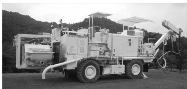
写真-1 一体型の吹付け設備
