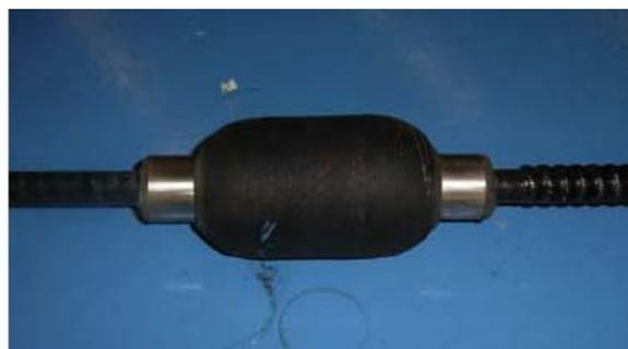
写真-2 機械式パッカー(膨張時)<sup>2)</sup>
