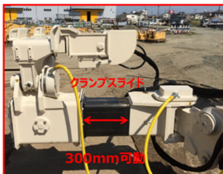
写真-4 クランプ部の水平スライド機能
