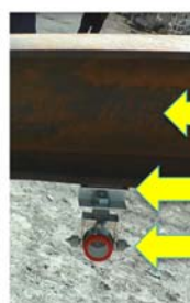
写真-3 測定用プリズムによる鋼製支保工位置の詳細表示
